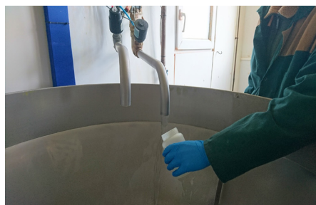
Prélèvement d'eau froide au niveau du mélangeur
