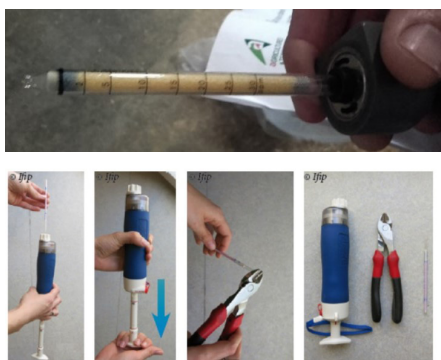
Evaluation de la concentration en gaz grâce à l'utilisation de tubes physico-chimiques
